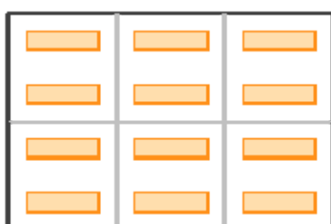
Ejemplos de distribución de luminarias en alumbrado general
